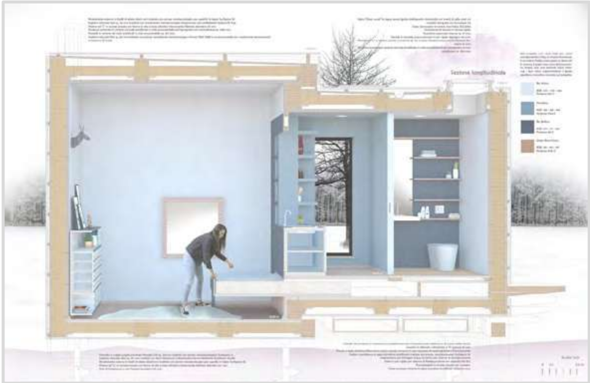
Figura 7 - Sezione longitudinale sui servizi.
